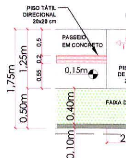
DETALHE REBAIXO Fonte NBR 9050/2003 escala 1/50
