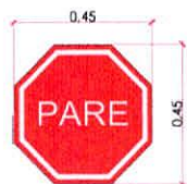
DETALHE PLACA DE SINALIZAÇÃO sem escala
